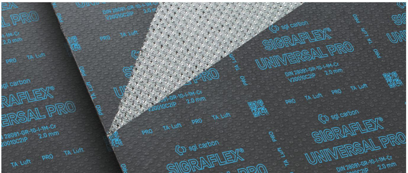
SIGRAFLEX UNIVERSAL PRO ist eine kleberfreie Graphitdichtungsplatte, bestehend aus flexibler Graphitfolie und verstärkt durch eine bzw. zwei Spießblecheinlagen aus Edelstahl 316 (L). Zur besseren Handhabung und zur Reduzierung der Leckage ist die Dichtungsplatte mit einer Imprägnierung versehen.
