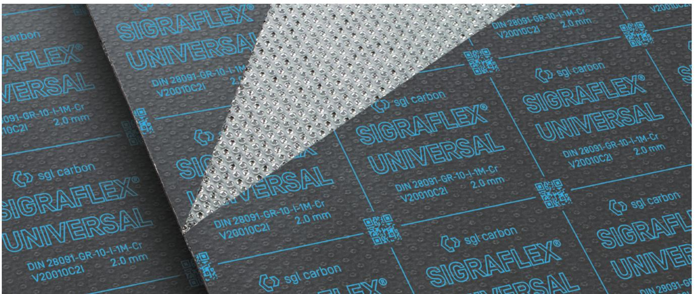
SIGRAFLEX UNIVERSAL ist eine kleberfreie Graphitdichtungsplatte aus flexibler Graphitfolie und verstärkt durch eine bzw. zwei Spießblecheinlagen aus Edelstahl 316 [L]. Zur besseren Handhabung und zur Reduzierung der Leckage ist die Dichtungsplatte mit einer Imprägnierung versehen.
