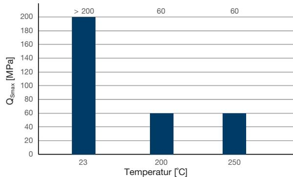
**Maximale Flächenpressung im Betriebszustand  $Q_{Smax}$  nach EN 13555**
